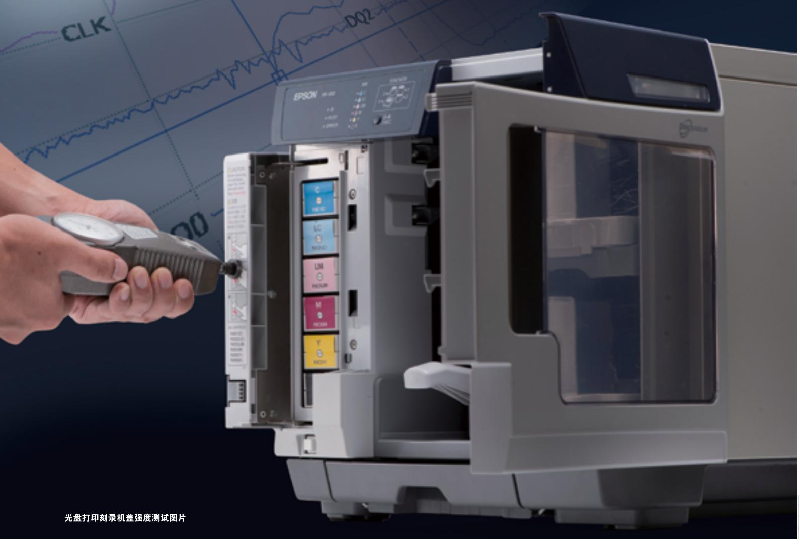
光盘打印刻录机盖强度测试图片
